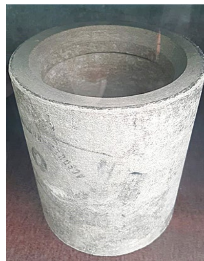
Рис. 6. Образец хризотилцементной трубы
